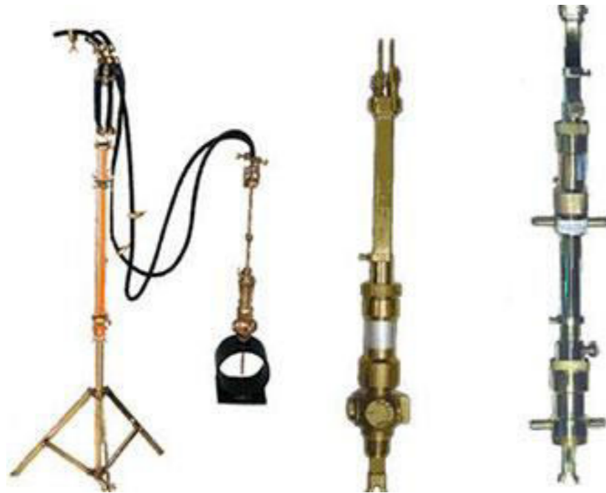
Figura 186 - Tubo Pitot tipo Cole.
